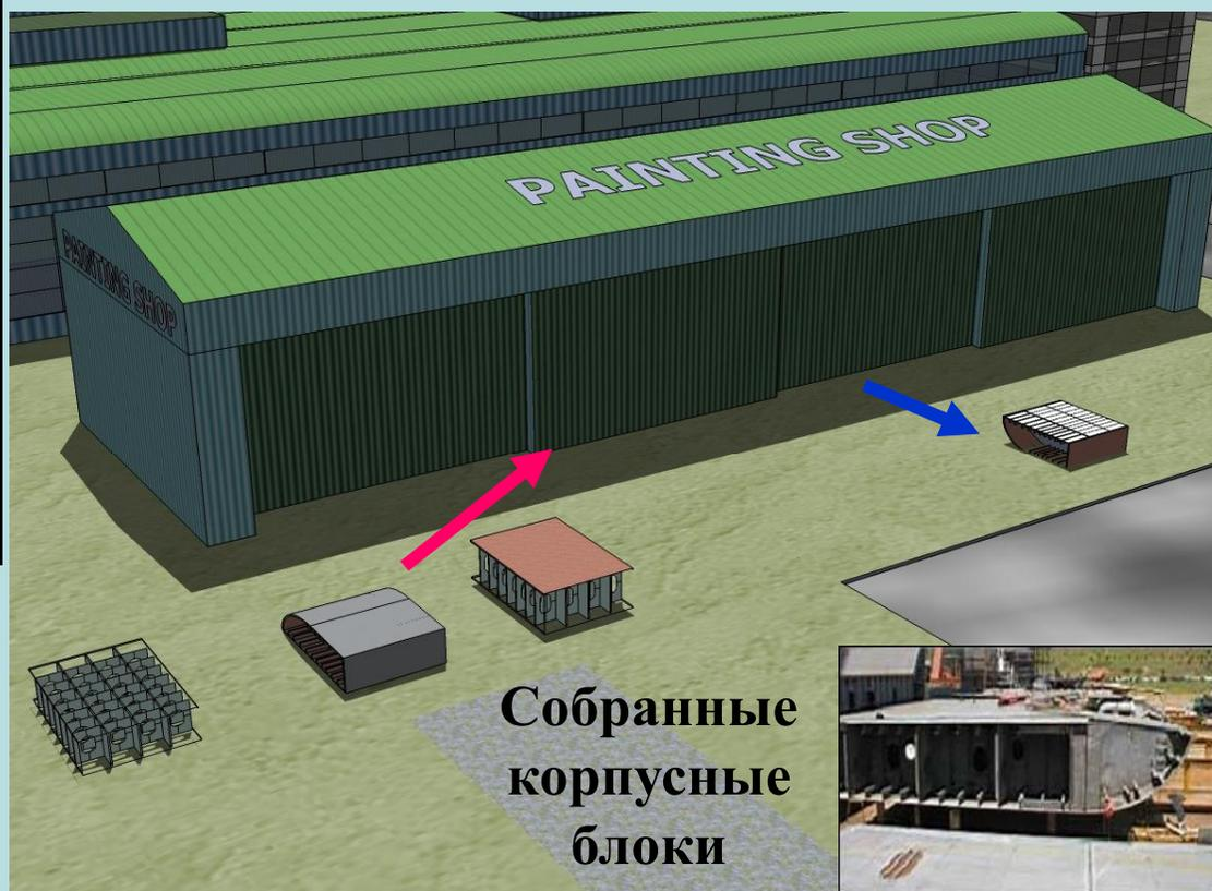
Собранные корпусные блоки будут окрашены после струйной очистки, а затем будут собираться до грузоподъемности главного крана, чтобы минимизировать количество работ на сборочном участке.
